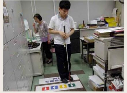
「アイ・ロード」S・K・Y 3タイプのシートを施工前の触感評価では『認識出来る』との評価をいただきました。また、3タイプごとの使い方のアドバイスもいただきました。
